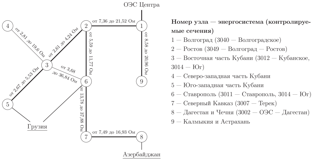
Рисунок 6.15 — Упрощенная схема связей в ОЭС Юга с указанием сопротивлений и дерева графа
