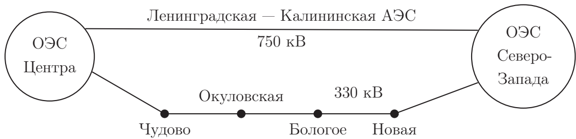
Рисунок 6.9 — Схема линий электропередачи между ОЭС Северо-Запада и ОЭС Центра
