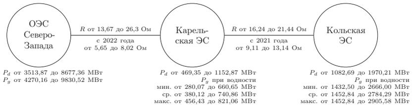
Рис. 14 — Структурная схема взаимосвязи энергосистем
