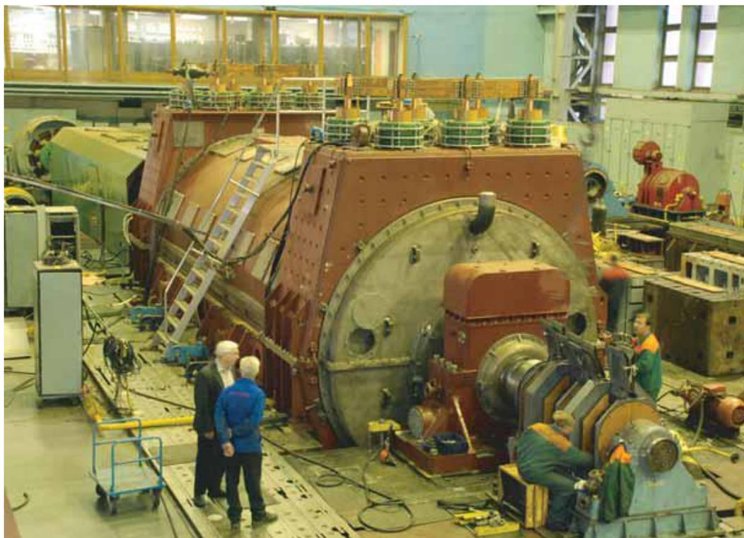
Рисунок 1.3 – Турбогенератор ТЗВ-1200-2АУ3 на испытательном стенде завода-изготовителя [16]
