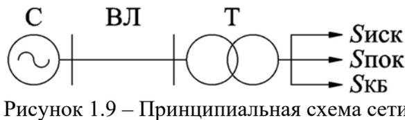
Рисунок 1.9 – Принципиальная схема сети
