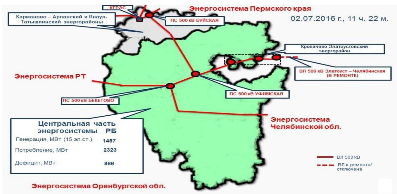
Рисунок 4.9 – План-схема сети 500 кВ ЭЭС РБ до возникновения каскадной аварии
