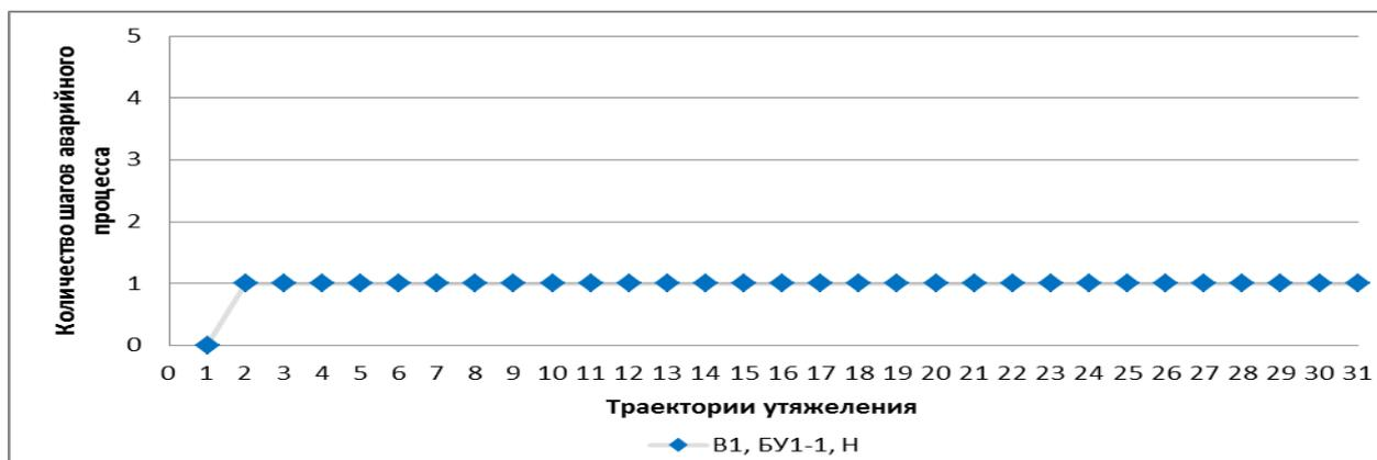
Рисунок 3.6 – Количество шагов в аварийном процессе для варианта неоднородности ЭЭС №1, БУ 1-1, способ утяжеления по потреблению
