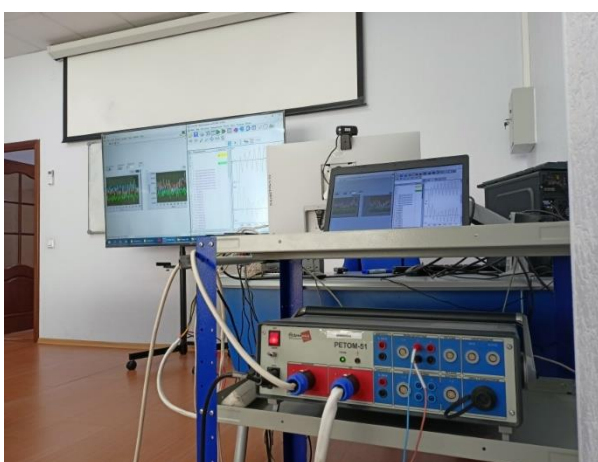
Рисунок 16 – Осциллограммы токов сторон, подаваемые от PETOM-51 при имитации реального переходного режима с насыщением трансформатора тока (а), фотография общего вида разработанного прототипа (б) и процесса его испытаний (в)
